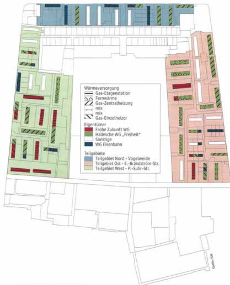
Ausgangslage der Energieversorgung im Energiequartier Halle-Süd zum Projektstart im Juni 2013 nach Bewirtschaftungseinheiten
